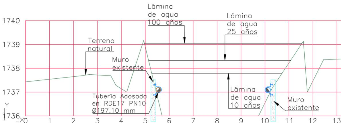
Esquema perfil transversal típica de la obra propuesta.
